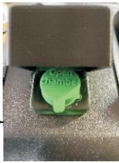
**1. Schritt - Starten Sie das Gerät. Öffnen Sie den Deckel der Messkammer und legen den grünen Button in die Messkammer.**
