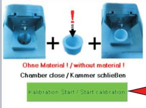
**2. Nehmen Sie den grünen Button aus der Messkammer und legen Sie jetzt zum Kalibrieren den leeren Messbecher in die Messkammer und drücken den Button „ Kalibration Start“**
