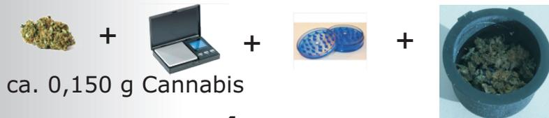
**4. Legen Sie nach der Kalibration das leicht zerkleinerte Material direkt in den Messbecher (bis das mittlere Hütchen im Becher gerade so bedeckt ist (siehe Bilder!!!), wenn Sie im Display dazu aufgefordert werden. Schließen Sie die Messkammer und drücken den Button „Messung starten“.** Es werden 320 Messungen pro Analyse durchgeführt.
