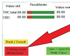
Auf Werkseinstellungen zurücksetzen. Alle Funktionen mit Ausnahme des Messzählers werden auf die Werkseinstellungen zurückgesetzt.
