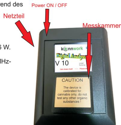
**Achtung: Nach jeder Messung sollte das Messgerät gereinigt werden. Schließen Sie zur Reinigung die Spannungsversorgung an, schalten Sie das Gerät ein (Power) und lassen Sie es für 1 bis 2 Stunden eingeschaltet (ohne Material in der Messkammer). So stellen Sie sicher, dass alle Moleküle verbrannt werden und die Start PPM wird gesenkt.**
