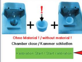
**2. Legen Sie zum Kalibrieren den leeren Messbecher** in die Messkammer und drücken den Button „Kalibration Start“
